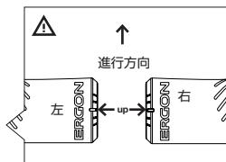
シフター、ブレーキレバーのクランプボルトを緩めてハンドルバー内側に寄せ、グリップを差し込みます。
