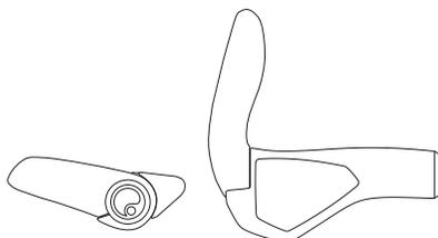
クランプを本締めし (推奨トルク値: 5Nm)、グリップが正しく装着されている事を確認し、エンドプラグを挿入します。
