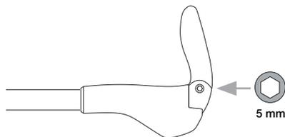
バーエンドの角度が調整できるようにクランプを仮留めします。
