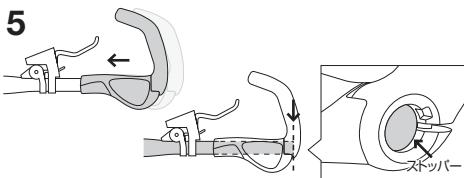
グリップをハンドルバーに挿入します。ハンドルバーがバーエンドのストップバーにあたる(バーエンドのインナーリングが、ハンドルで完全に隠れる位置)まで、挿入してください。
