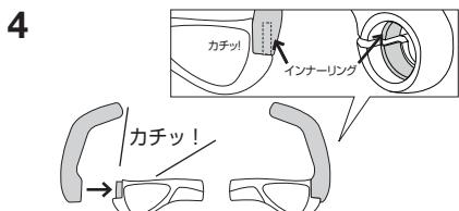
グリップ本体にバーエンドを取り付けます。バーエンドのインナーリング(図 参照)と、グリップ端部が接触する位置になっていることを確認してください。
