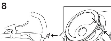
エンドプラグの凸部とバーエンドの凹部の位置を合わせて、エンドプラグを取り付けます。
