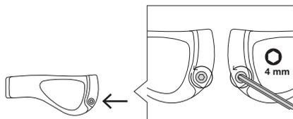
グリップのクランプ ボルトを4mm 六角レンチを使用して、反時計回りに3~4 回転させて緩めます。
