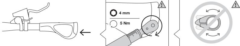
トルクレンチを使用してクランプボルトを締めます。(推奨トルク値: 5Nm)
