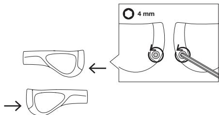
グリップのクランプボルトを4mm六角レンチを使用して、反時計回りに3~4回転させて緩めます。
