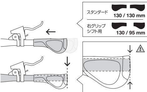
シフター、ブレーキレバーのクランプボルトを緩めてハンドルバー内側に寄せ、グリップを差し込みます。グリップの端面とハンドルバーの端面が揃う位置まで完全に差し込んでください。
