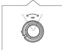
クランプ側面のUPマークがハンドルバーの直上になる角度を基準に、好みの角度にグリップを調整します。
