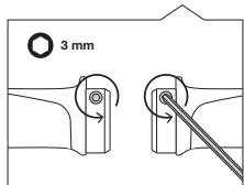
グリップのクランプボルトを約3~4回転させて緩めます。
