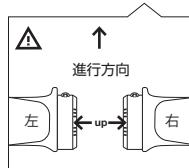
シフター、ブレーキレバーのクランプボルトを緩めてハンドルバー内側に寄せ、グリップを差し込みます。グリップが止まるまで完全に差し込んでください。
