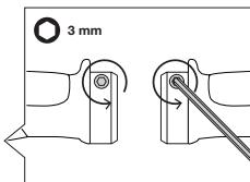
グリップのクランプ ボルトを3mm 六角レンチを使用して、反時計回りに3~4回転させて緩めます。
