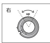
クランプ側面のUPマークがハンドルバーの直上になる角度を基準に、好みの角度にグリップを調整します。
