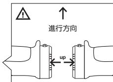
シフター、ブレーキレバーのクランプボルトを緩めてハンドルバー内側に寄せ、グリップを差し込みます。グリップが止まるまで完全に差し込んでください。
