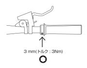
クランプ側面の UP マークがハンドルバーの直上になる角度を基準に、好みの角度にグリップを調整します。
