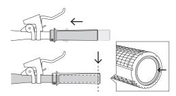
グリップの左右を確認します。グリップのクランプ ボルトを 3mm 六角レンチを使用して、反時計回りに 3~4 回転させて緩めます。 シフター、ブレーキレバーのクランブボルトを緩めてハンドルバー内側に寄せ、 グリップを差し込みます。グリップが止まるまで完全に差し込んでください。
