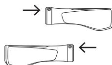
グリップのクランプボルトを約3~4回転させて緩めます。
