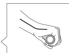
3mm六角レンチ、トルクレンチを使用して固定します。(推奨トルク値：3Nm)グリップがしっかりと固定されていることを確認してください。
