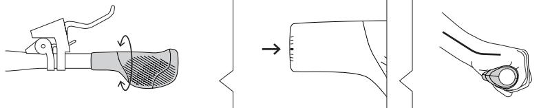
クランプ側面のUPマークがハンドルバーの直上になる角度を基準に、好みの角度にグリップを調整します。
