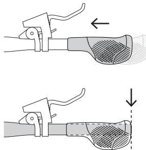
グリップのクランプ ボルトを3mm六角レンチを使用して、反時計回りに3~4回転させて緩めます。
