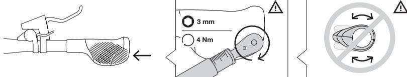
トルクレンチを使用してクランプボルトを締めます。(推奨トルク値: 4Nm) グリップがしっかりと固定されていることを確認してください。
