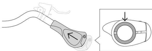
シフター、ブレーキレバーのクランプボルトを緩めてハンドルバー内側に寄せ、グリップを差し込みます。グリップの端面とハンドルバーの端面が揃う位置まで完全に差し込んでください
