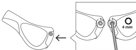
グリップのクランプ ボルトを 4mm 六角レンチを使用して、反時計回りに 3~4 回転させて緩めます。
