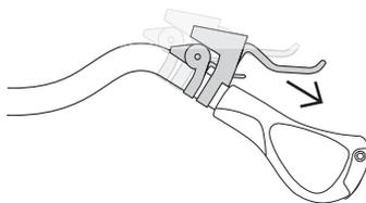
シフター、ブレーキレバーを適切な位置に移動し、クランプボルトを締めて固定します。
