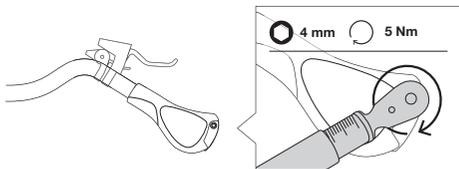
トルクレンチを使用してクランプボルトを締めます。(推奨トルク値：5Nm)
