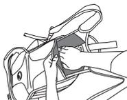
バックパックとショルダープレートを繋いでいるベルクロを剥がします
